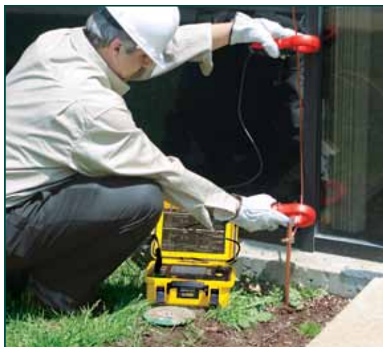
El modelo 6471 mide rápida y fácilmente el valor de la tierra usando el método de doble pinza (no se requieren jabalinas auxiliares).
